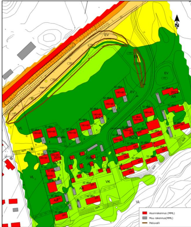
RAMBOLL 1510047470 Vuolteenpellon asemakaavan meluseelvitys Kuva 3.1 Päiväjän meluyöhykkeet L_{Aeq} \geq 22 - Vuoden 2030 mukainen ennusteliikenne Äänitaso (dB(A)) 70 < -> 70 65 < -> 65 60 < -> 60 55 < -> 55 50 < -> 50 45 < -> 45 Mittakaava (A4) 1:2000 Laskentakorkeus mp + 2m 07/03/2019 V.Virtanen
