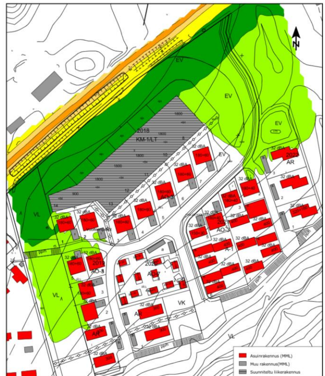
RAMBOLL 1510047470 Vuolteenpellon asemakaavan meluseelvitys Kuva 4.2 Yöajan meluyöhykkeet L_{Aeq} \geq 27 - Vuoden 2030 mukainen ennusteliikenne Äänitaso (dB(A)) 70 < -> 70 65 < -> 65 60 < -> 60 55 < -> 55 50 < -> 50 45 < -> 45 Mittakaava (A4) 1:2000 Laskentakorkeus mp + 2m 07/03/2019 V.Virtanen
