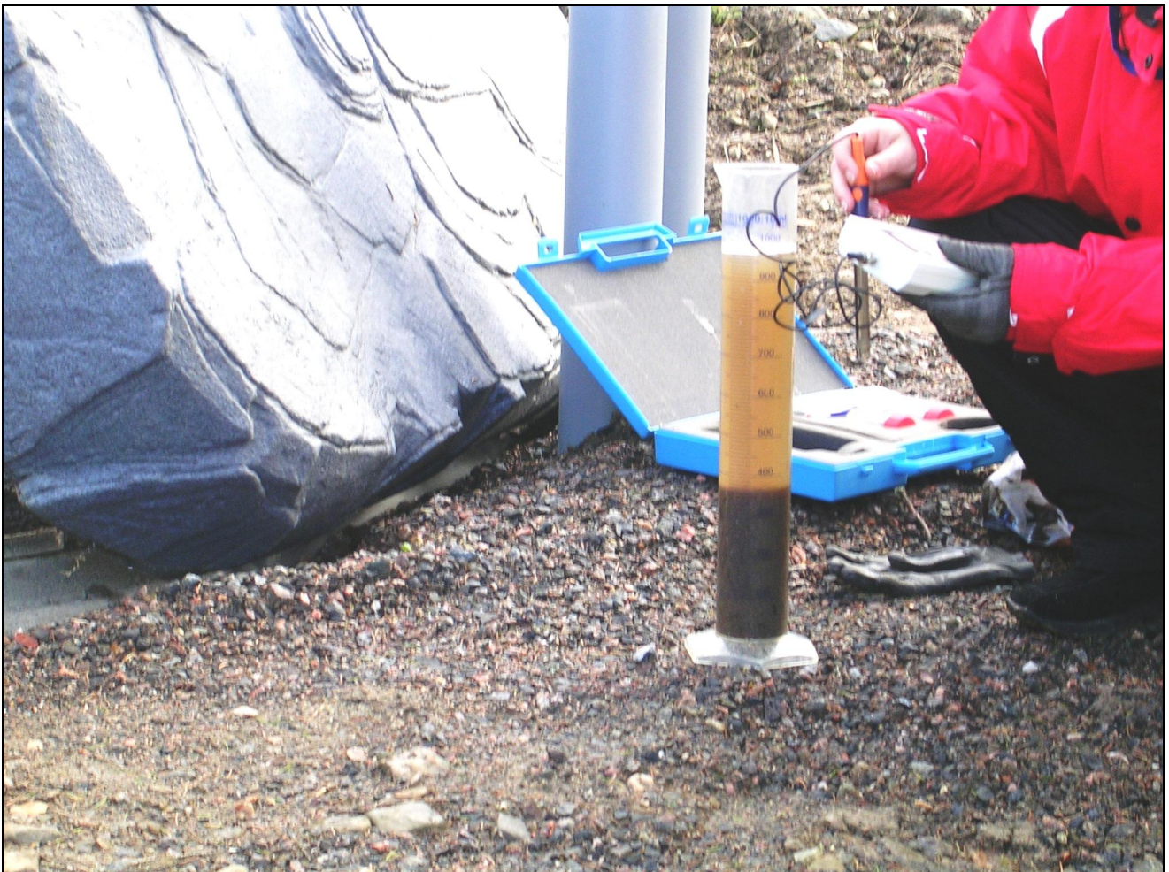
Panospuhdistamon ilmastuslietteen laskeutuskoe ja pH-mittaus.
